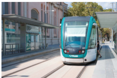
写真3-4-1 バルセロナの100%低床トラム
