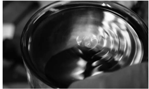
図11 (0-0) モード発生時のグラス 表面の振動
