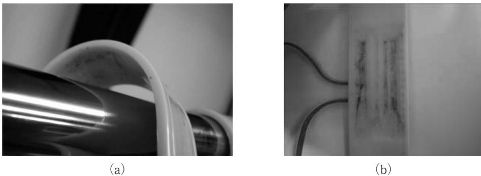
図13 つり手のベルトとパイプの摩擦によりきしり音が発生した時のベルトとパイプの接触面の写真およびベルトの内側に付着した摩耗粉による痕跡
