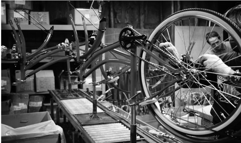
図ー11 サカイサイクルの本社工場のカスタマイズ用の手押し組立ライン
