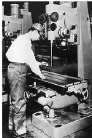
図-1 YUD700 大型直立ボール盤の完成品検査の実習中の筆者（1967年6月）
