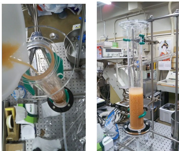
Fig 2.31 Pour resin into the column.
