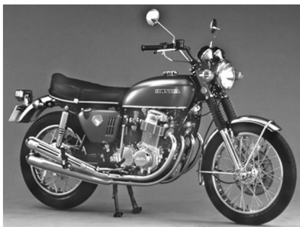
図2-1 CB750FOUR 4サイクル 4気筒 750cc
