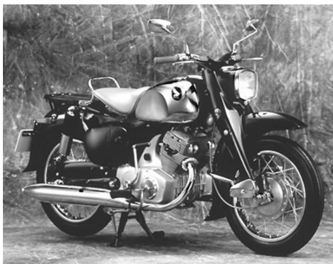
図1-1 C70型ドリーム号 4サイクルOHC 2気筒
