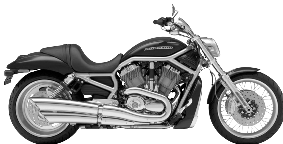
図 4-1 ハーレーの V-ROD（1131cc） DOHC 水冷 V ツインエンジン
