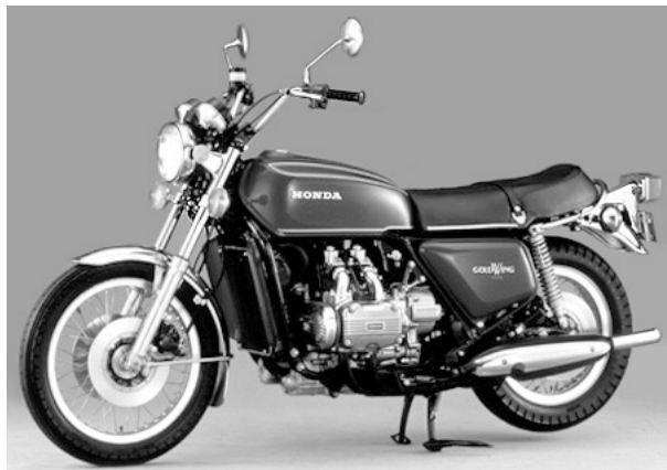
図3-2 GL 1000 水平対向4気筒 1000cc 水冷エンジン シャフトドライブ
