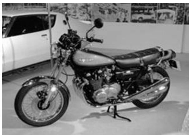
図3-1 900SUPER 4（Z1）4サイクル DOHC 4気筒 900cc
