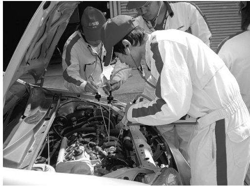
図13 サウンドスコープを用いて実車の故障診断をしている学生
