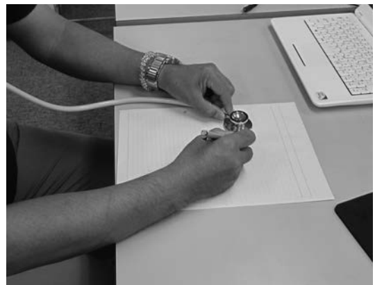
図10 シャープペンシルで紙に文字を書く時の芯と紙とのこすれる音
