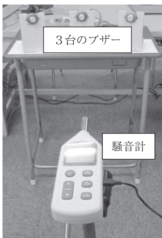
図31 ブザーを用いた音圧レベル加算の実験
