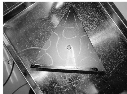
図2 実験によるクラドニ図形の一例（三角板）
