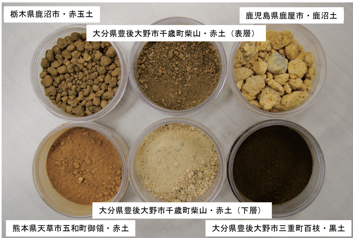
図 3.78 栃木県鹿沼市産の赤玉土とりん吸着係数上位 5 種の土壤
