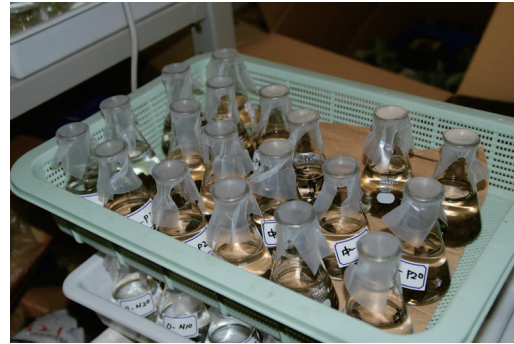
図 4.18 回分式吸着試験
