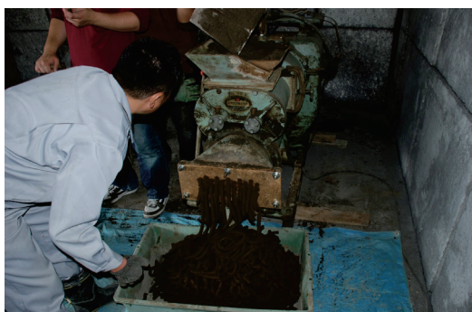
図 4.8 押出成形中の浄化材
