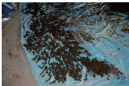
図 4.9 養生中の浄化材
