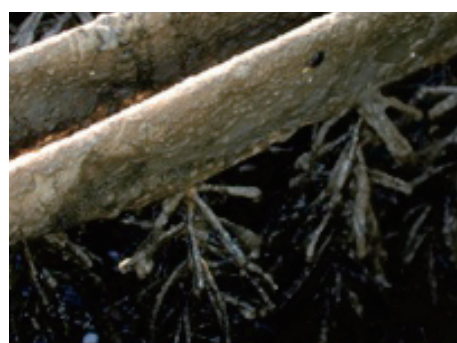
図 5.16 揺動床式生物接触担体への 微生物付着状況
