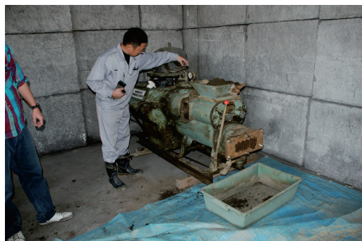
図 4.7 土練機 (押出成形式造粒装置)
