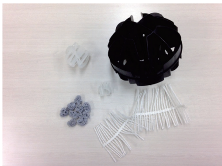
図 5.4 接触曝気法用生物担体
