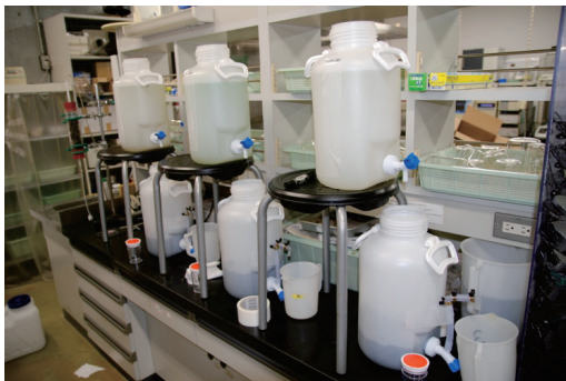
図 4.13 吸着寿命簡易予測実験
