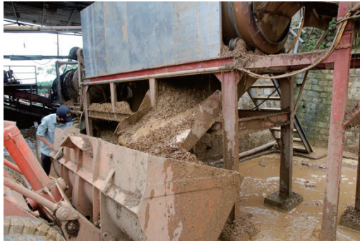
図 2.12 キャッサバ根茎の洗浄工程
