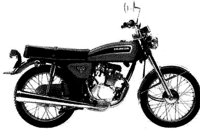
図-3 パイプフレーム構造のCG125
