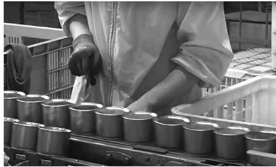
図13 缶詰工場における打音による検査風景
