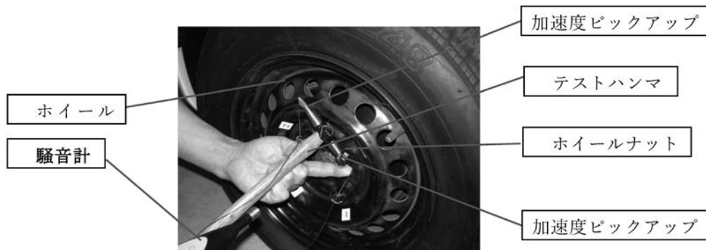
図7 ホイールナットのゆるみを診断している様子
