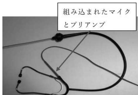
図10 改造したサウンドスコープ
