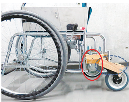
図3 改良前輪車いす 従来キャスタ固定（ ○ ）および補助キャスタ1輪追加と固定（ ○ ）
